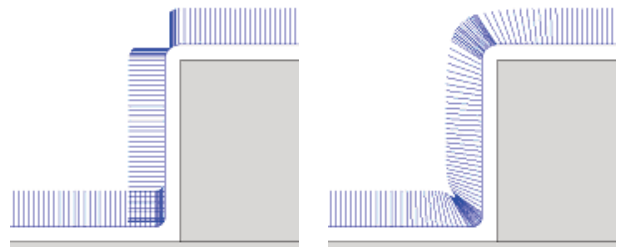
Fig. 7 Il est rare d'usiner une pièce avec l'outil strictement normal aux surfaces.
