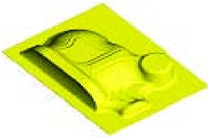
Modèle de brut après ébauche avec outil D20R3
