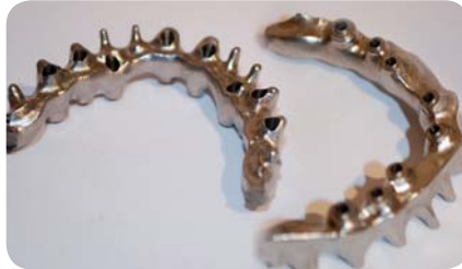
Usinage d'implants en barres de titane sur machine 5 axes
