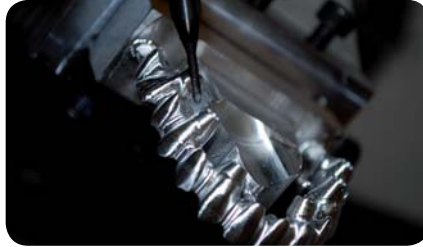
Usinage d'un bridge complet sur piliers en chrome-cobalt sur machine 5 axes
