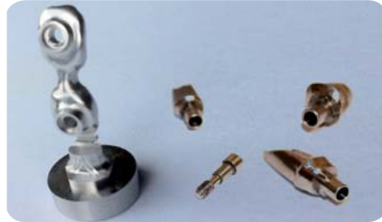
Usinage automatique de contre-dépouilles en 5 axes
